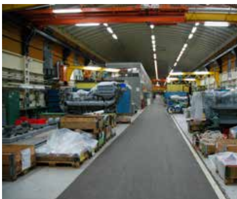
En av verkstadstunnlarna i sin fulla längd, 196 meter lång och med en takhöjd på 14 meter. Här ses maskinverkstadsens tunnel.
